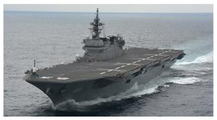
「いずも」型へリ搭載護衛艦 (19,500t、ヘリ 14機 搭載 [公式には9機]) は、「しらね」型 ヘリコプ ター搭載護衛艦 (5,200 t、ヘリ3機搭載) の代替 艦として建造された。
